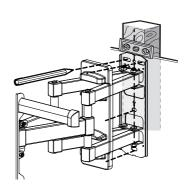
Drill pilot holes at marked locations (x4). 在标注处钻孔(x4)。
