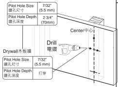
Attention: the holes on the top and the bottom must be drilled at the stud. 注意:頂上的孔跟底下的孔必須打在木立柱上。
