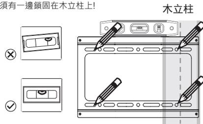
4 使用十字螺絲起子將墊片與螺絲 (x4) 固定在牆上。
