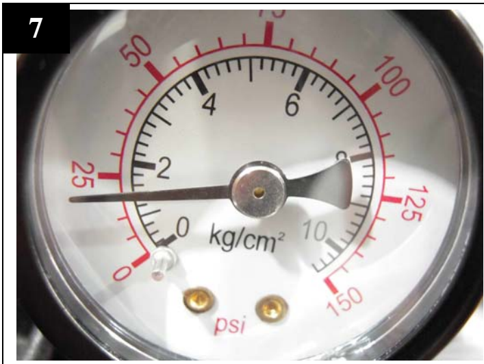
7 使壓力降至設定啟動壓力 ※啟動壓力設定請參照使用說明書
