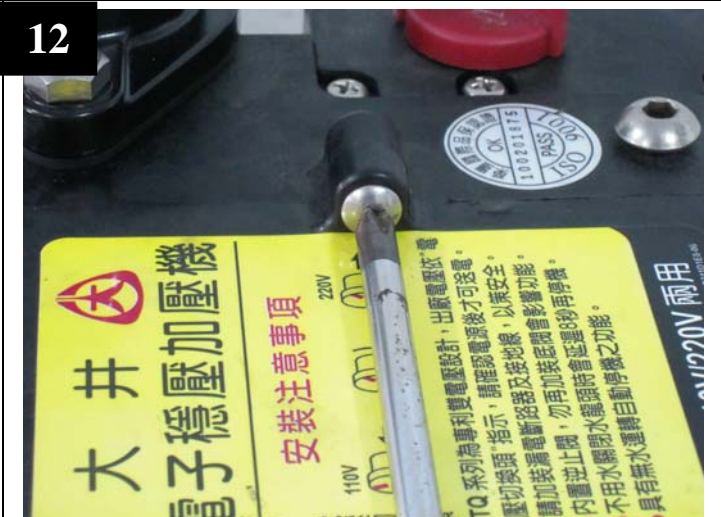
12 利用十字起子鎖上 3 支固定螺絲 ※扭力設定 15-20 kgf · cm
