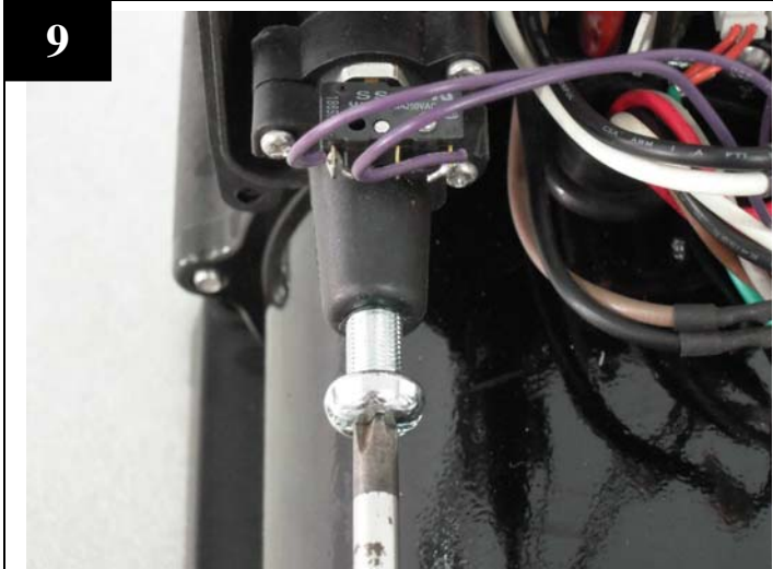
9 利用十字起子順時針調整壓力開關調壓螺栓至泵浦啟動
