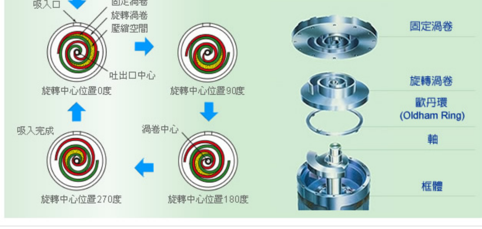
渦卷式壓縮機的壓縮原理
