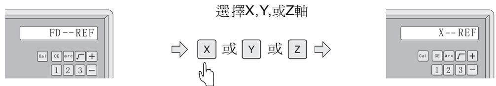
步驟3：搖動機床X方向的手輪，移動工作臺，數顯表會自動尋找並記憶X軸光柵尺的機床零點，找到機床零點後，找到並記憶後，信息窗會快速顯示：Find X，然後顯示：FD--ORG，按Y或Z再重複以上操作可繼續設定Y軸和Z軸的機床零點。
