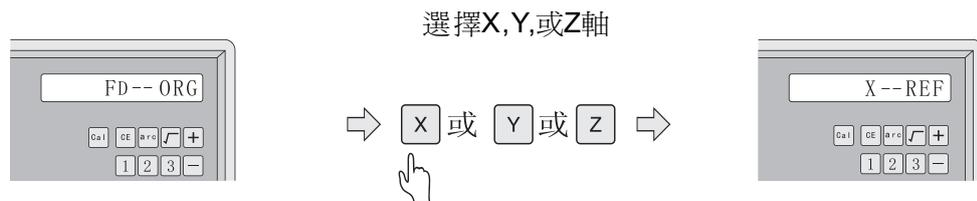
步驟3：搖動機床X方向的手輪,移動工作臺,數顯表會自動搜尋X軸光柵尺的機床零點,找到機床零點後,信息窗會快速顯示:Find X,然後顯示:FD--ORG按[Z]或[Y]再重複以上操作可繼續找出Y軸和Z軸的機床零點。
