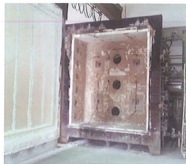
燃燒 4 小時後，依然保持牆體的完整性，同時板材或白磚上幾乎無裂縫
