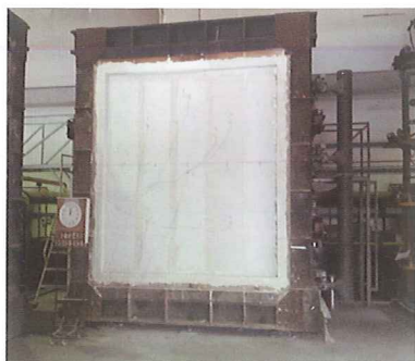
3 x 3 米，10 公分厚伊通輕質牆體經歷 4 小時防火測試
