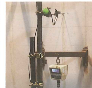
兩點固定可承載 150 kg 的重量 (模擬洗臉盆)
