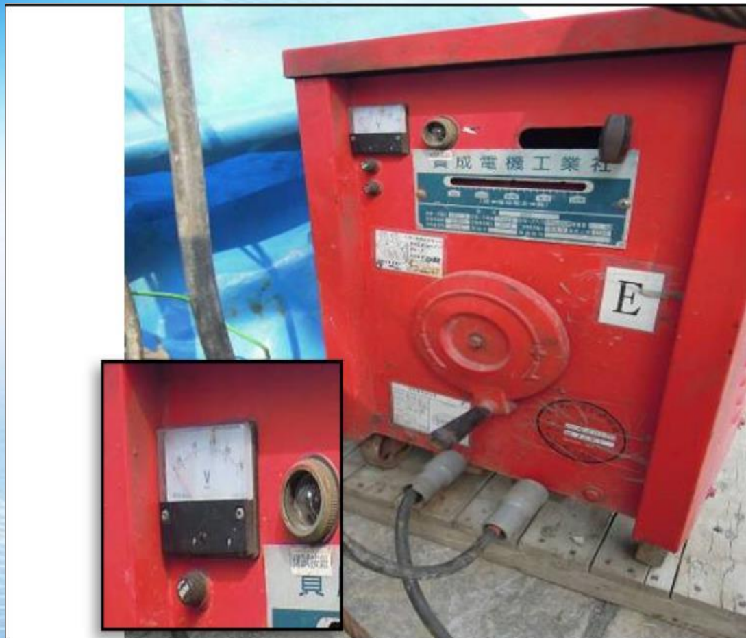
◎交流電焊機內藏式自動電擊防止裝置+電壓指示表
