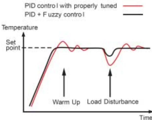
**高精度：**本系列溫控器的製造採用了客製化 ASIC 技術，包含 18-bit 高解析度的 A-D 轉換功能 (熱電耦與 PT100 解析度達 0.1 )與 15-bit D-A 轉換線性電流或電壓的控制輸出功能。ASIC 技術改善了控制器的表現，降低成本，也增強了控制的信賴度提高控制的精確度。
