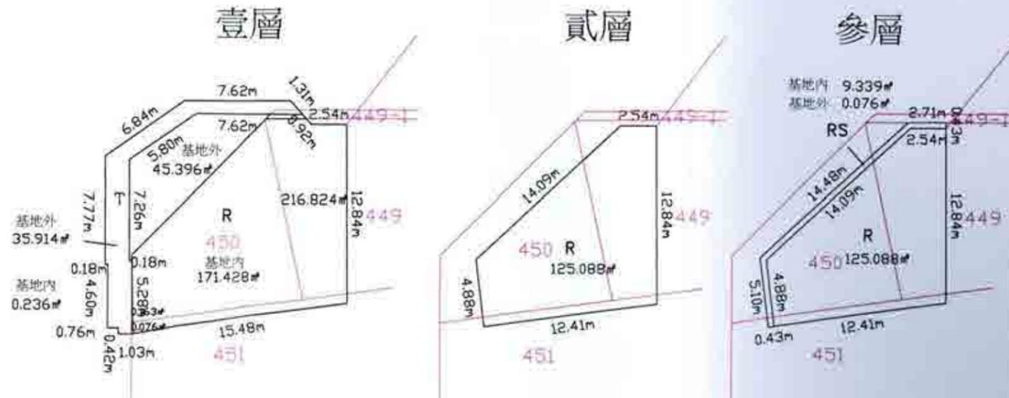
面積:平方公尺 R:加強磚造 T:鐵皮棚 M:鋼架鐵皮 B:磚造屋 RS:水泥雨遮
