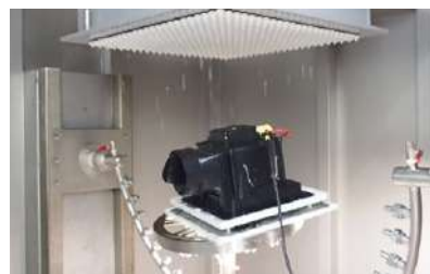
防水等級測試設備 防潮與灑水測試
