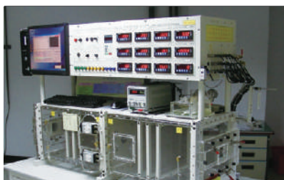
風洞測試設備 風壓風量測試
