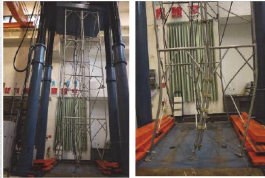
762 型框式施工架雙拼並增加萬向扣鎖之底層加壓測試情形
