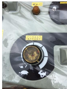
(動作速度調整電位計位置相片)
