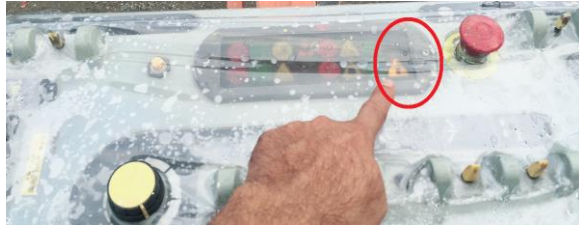
圖二：第一段警示柴油加油燈
