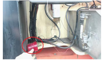
圖三：第二段警示柴油加油燈
