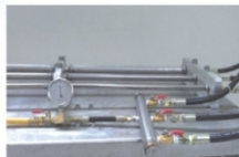
擺動水壓試驗 (水壓加至25kgf/cm 2 )
