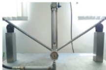
耐壓試驗、水壓試驗、彎曲試驗 (水壓加至25kgf/cm 2 )
